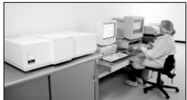
薄膜コーティングの波長特性の測定には分光計を用いています。
